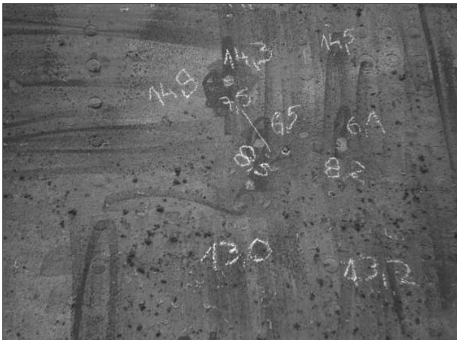
■ Slika 11. Mb Galeb – mjerenje debljine lima, siječanj 2010. (arhiva Grada Rijeke)
